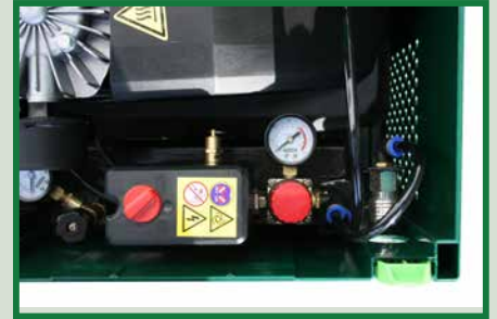
Geregelter Druckluftausgang mit Druckminderer und Manometer
