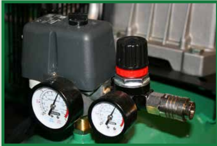
Manometer für Kessel- und Ausgangsdruck
