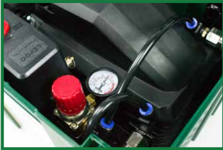
Druckmanometer für Kesseldruck
