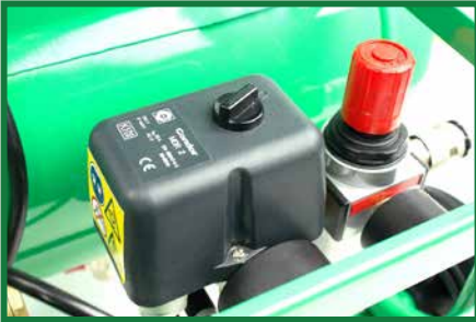
Filterdruckminderer mit Wasserabscheider und Manometer
