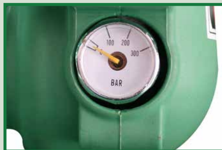
Füllstandanzeige der Druckluftkartusche
